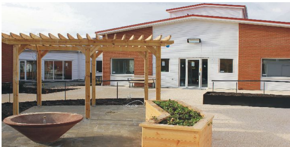
Underlaget på Södergårdens nya innergård blir ljusst och jämnt. Upphöjda odlingslådor ska möjliggöra bärplockande från rullstolen.
